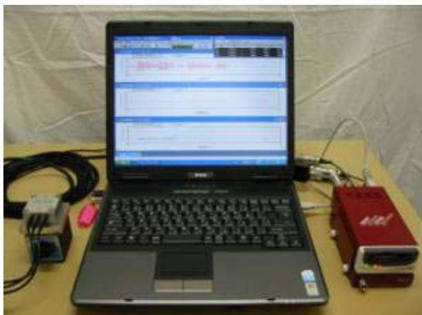
図 11.7 加速度計（左）とレコーダ（右）
