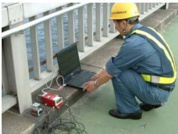
図 11.8 測定作業の実際（佃大橋歩道上）。モバイルパソコンはモニタです。無くても作業はできます。
