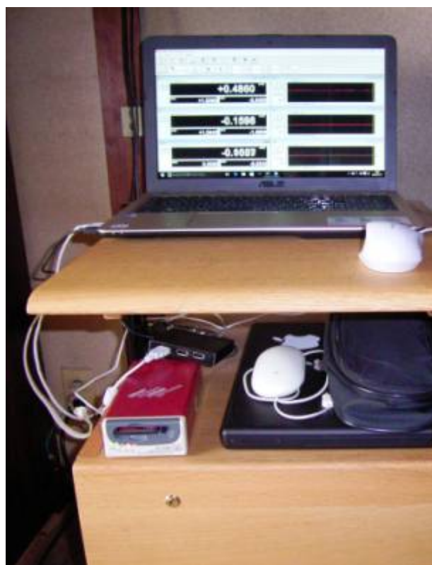
図19 ベッド横のサイドテーブル上に置いたモニタ。下段にあるのが小型振動測定器本体です。加速度計は写っていませんが、壁に沿わせてあります。
