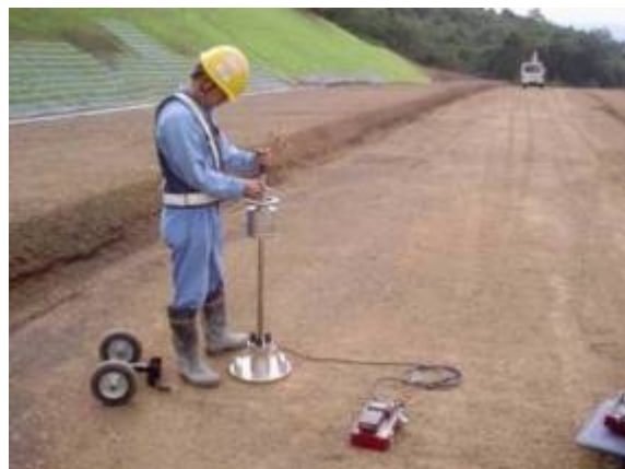
図4. 小型の FWD 用加振機を使う例
