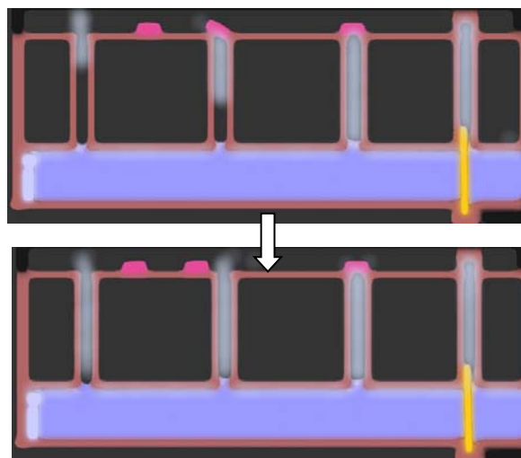
図-21 ゲート遮断後の水位変動
