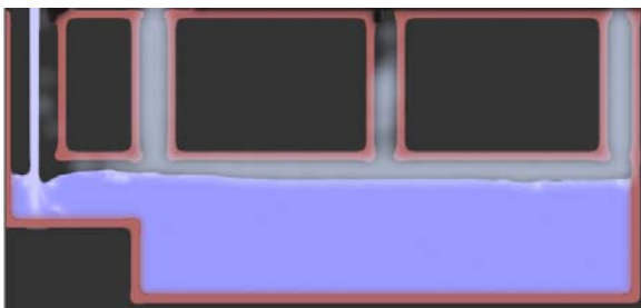
図-13 空気抜3箇所所有する貯留槽流入
