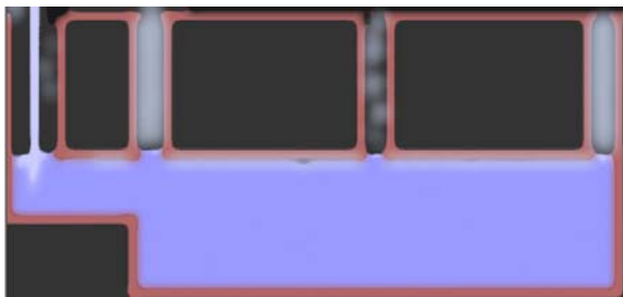
図-14 空気抜3箇所所有する貯留槽満水
