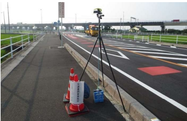
図 9 ビデオカメラの設置状況
