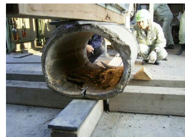
写真-1 経年管の外圧試験の様子 6)
