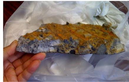
写真2 落下したヒューム管の破片
