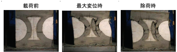
(b) NM+鉄筋 変形状況
