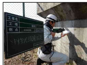
写真-4. 中性化に対する試験の実施
