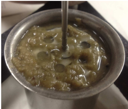
写真-3 重力濃縮汚泥のフロック
