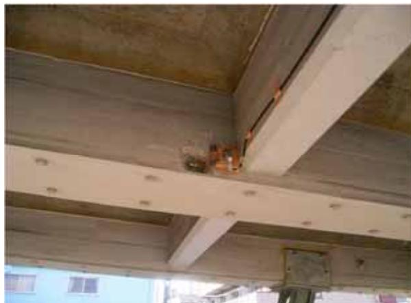
写真-5 ひずみゲージ設置状況
