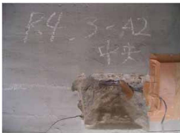
写真-6 主筋へのひずみゲージ貼付状況
