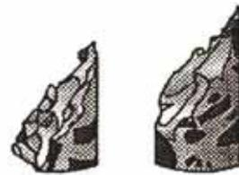
(b) 斜めの面で破壊し、2つに分かれる。モルタル面で破断したような跡が認められる。
