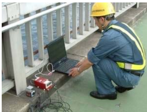
図 9： 測定作業の実際 (佃大橋歩道上)。 パソコンはモニタ。無くても作業はできる。
