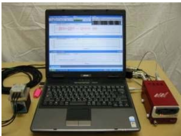
図 8： 加速度計 (左) とレコーダ (右) 野外作業に向くような簡易化が重要
