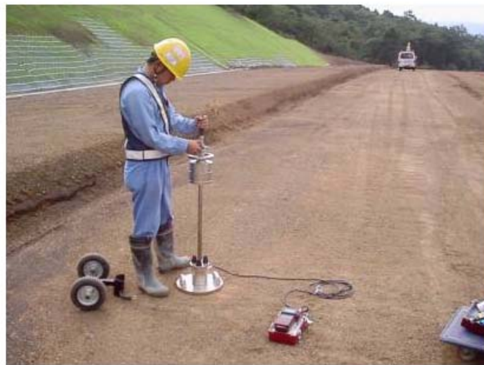
図6：路盤テストに使う簡易重錘落下装置(FWD)
